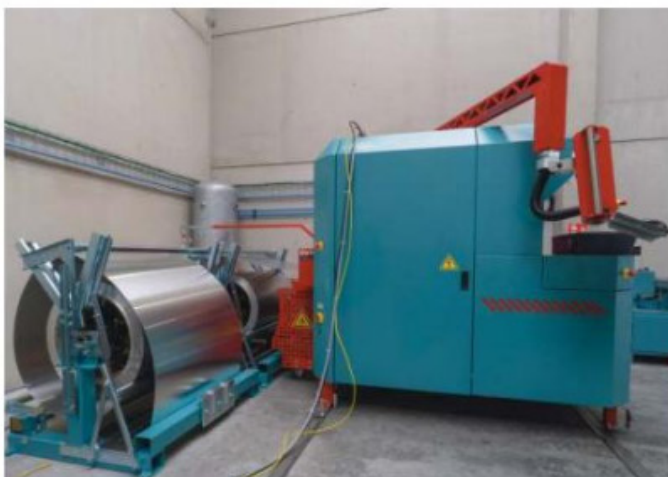
De Mabi Bingo 16-Z EVO is uitgerust met een inrichting voor twee coils, indachtig het door V.I.P.B op klantvraag meest toegepaste materiaal: 0,8 mm en 0,6 mm aluminium glad of stucco.
