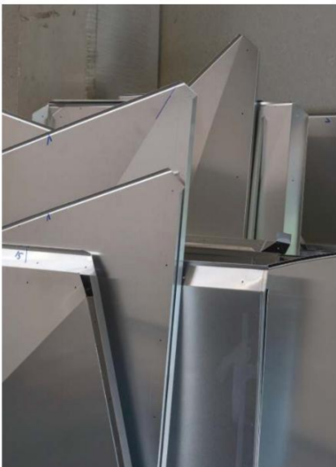
Een groot deel van de luchtkanaalonderdelen inclusief complete kokers is in een enkele productiestap te maken.
